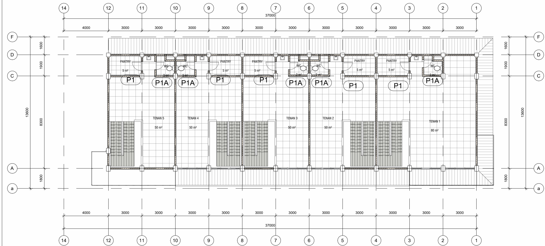
1 DENAH FINISHING KUSEN PINTU JENDELA LT. 2 1 : 150
